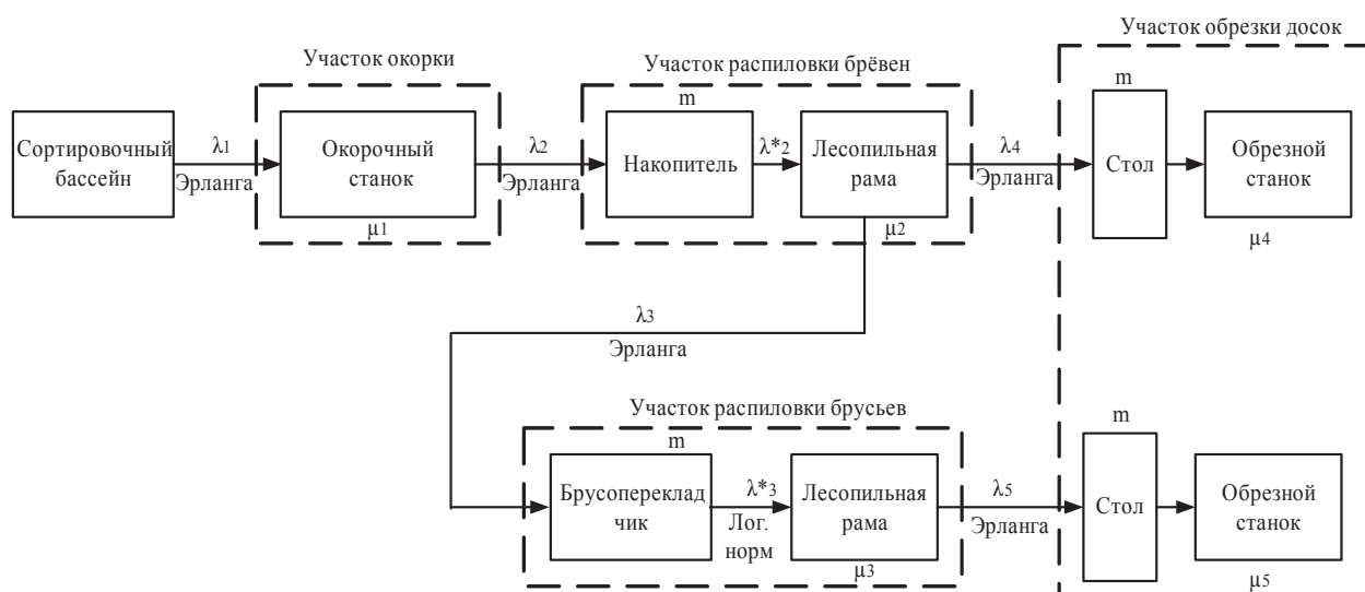
Рис. 1. Сетевая модель поточной линии производства пилопродукции Fig. 1. Network model of sawn timber production line
