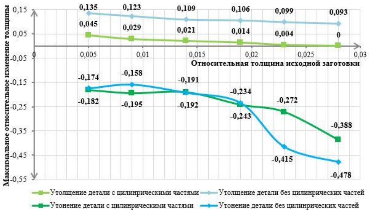
Рисунок 4. Зависимости максимального относительного утолщения и утонения полученной детали от относительной толщины исходной заготовки
