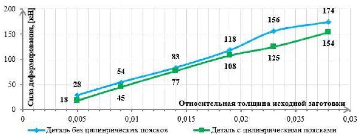
Рисунок 3. Зависимости силы деформирования от относительной толщины исходной заготовки
