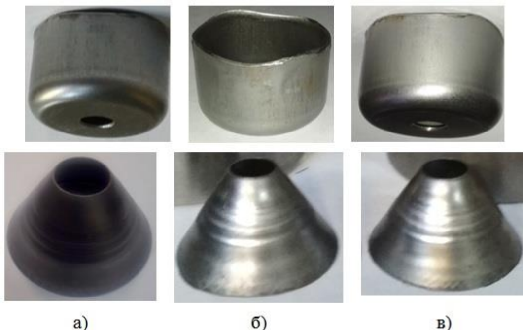
Рисунок 12. Полученные вытяжкой стаканчики с отверстием в доньшке высотой: а) 24,8 мм; б) 33,4 мм; в) 31 мм и полученные совмещением детали из них
